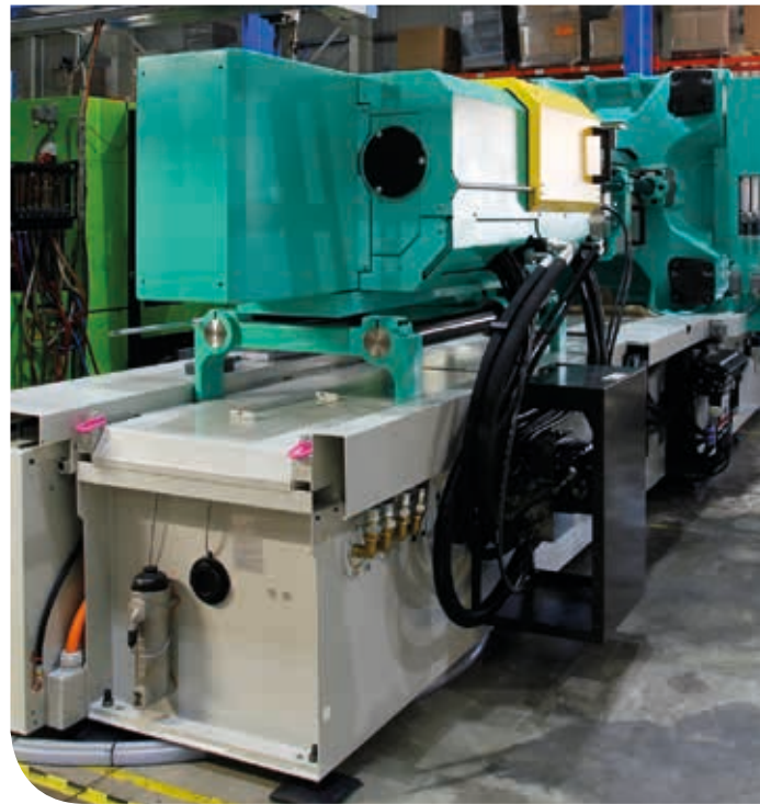
Mangueras con calefacción eléctrica aplicadas en el moldeo por inyección. El plástico líquido debe mantenerse a una temperatura constante.
