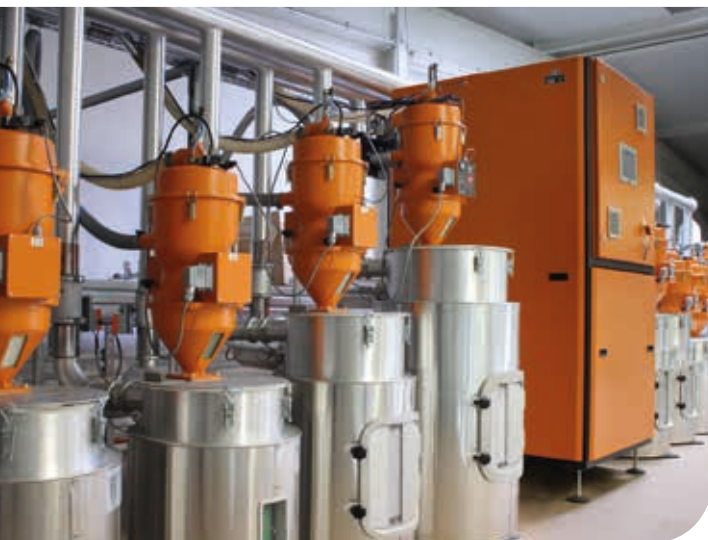
Mangueras de succión y de transporte utilizados para el llenado de secadoras de granulados junto con mangueras resistentes a altas temperaturas para transportar el aire caliente a la secadora.
