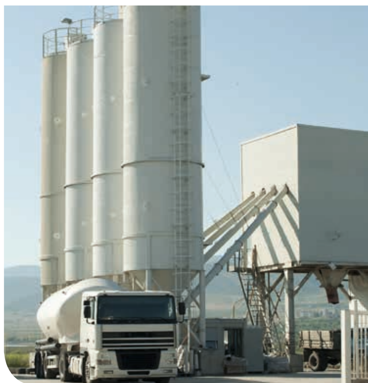
Entrega de granulados de plástico y llenado de silos con transportadores neumáticos
