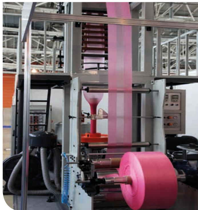
Mangueras resistentes a las temperaturas utilizadas para la extracción de aire caliente para la fabricación de plásticos de burbujas
